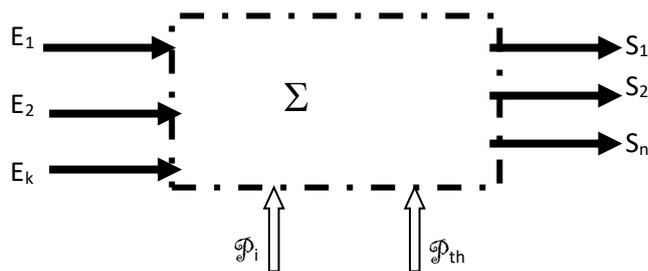
Un fluide entre dans  $\Sigma$  par  $k$  entrées ( $E_1, E_2, \dots, E_k$ ) avec les débits massiques respectifs  $D_{E1}, D_{E2}, \dots, D_{Ek}$  et sort de  $\Sigma$  par  $n$  sorties ( $S_1, S_2, \dots, S_n$ ) avec les débits massiques respectifs  $D_{S1}, \dots, D_{Sn}$ . Le premier principe (appelé par la suite 1° principe industriel) s'écrit alors, en négligeant les
