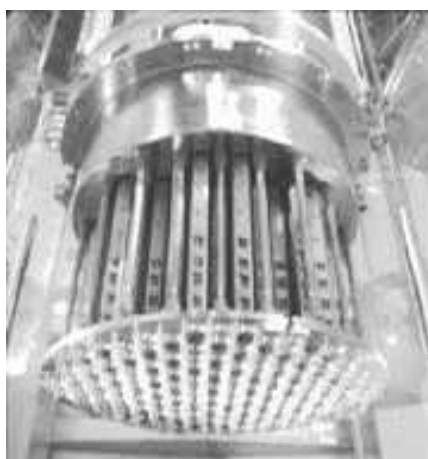
Vue de l'ensemble des tubes de guidage et de leurs supports
