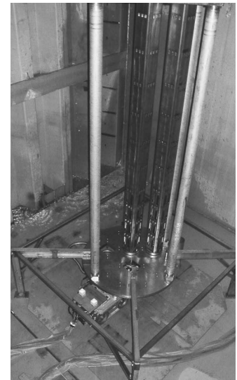
Vue du système éclipse au cours d'essais de validation. On distingue le support de rehausse des tubes posé au fond de la piscine
