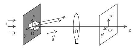
Un point M de l'ouverture du diaphragme est repéré par ses coordonnées x et y et l'axe Oz est perpendiculaire au plan du diaphragme.
