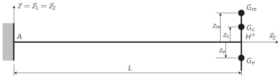
Figure 21 – Paramétrage de la position des centres de gravité du plateau de chargement et de son étuve, noté G_e , du chargement noté G_c , et de la masse mobile noté G_m (ici z_e < 0 )
