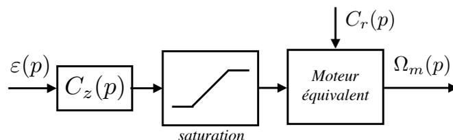
**Figure 33** – Positionnement de la saturation dans le schéma-blocs complet du système
