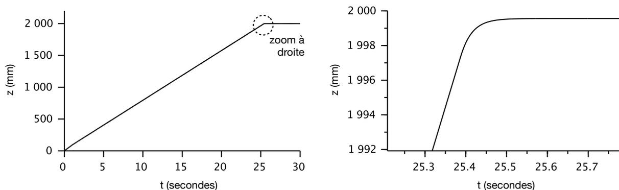
**Figure 34** – Évolution de la hauteur de l'élément de parterre en fonction du temps : réponse à un échelon d'entrée de 2000 mm à l'instant  $t = 0$  sous chargement équivalent de -10 Nm
