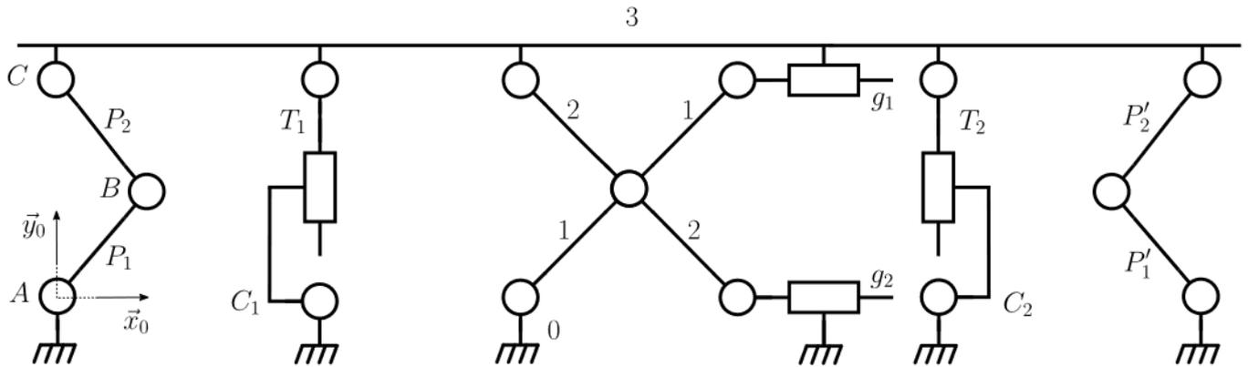
Figure 24 – Schéma cinématique du gradinage d'orchestre isostatique en étude plane
