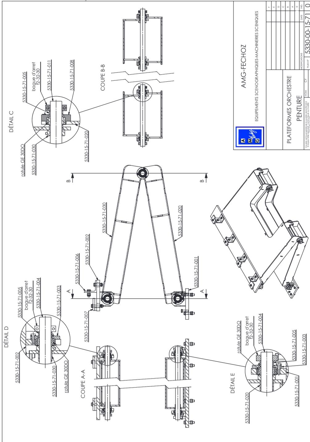
Figure 36 – Dessin technique de définition d'une penture
