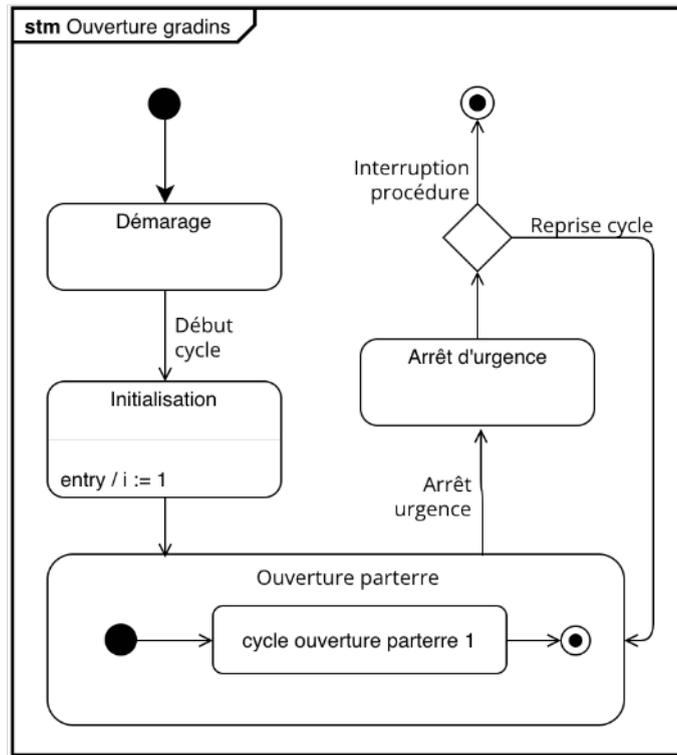
Figure 12 – Diagramme d'état général d'un changement de configuration du parterre (élévation des gradins)
