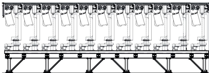
**Figure 7** – Vue en coupe des gradins du parterre en configuration debout (parterre escamoté)
