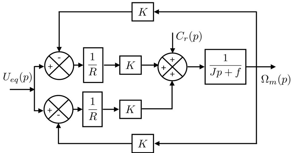
**Figure 30** – Schéma-blocs de la modélisation retenue pour deux moteurs accouplés au même arbre
