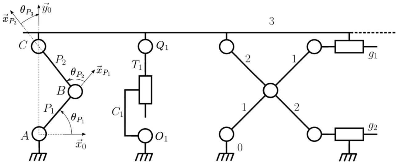
**Figure 25** – Schéma cinématique du gradinage d'orchestre simplifié
