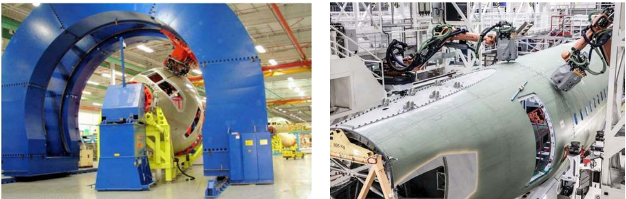
Figure 1 : Machines spéciales de grand gabarit et cellules robotisées pour l'assemblage de structures d'avion
