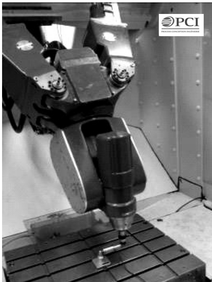
Figure 4 : Broche de la machine Triptéor
