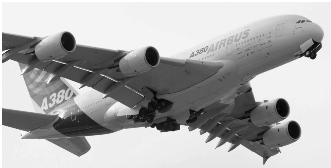
Figure 3 : sortie des trains d'atterrissage sur l'A380
