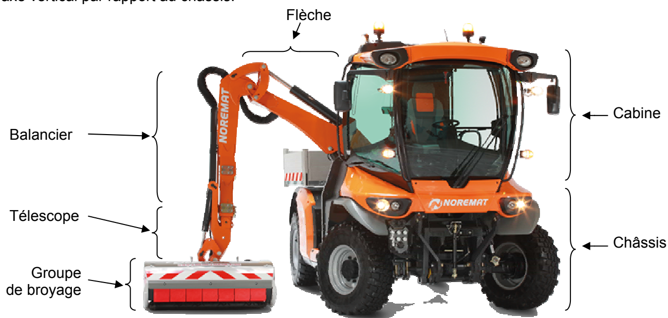
Figure 2 : Véhicule VSV équipé d'un groupe de broyage
